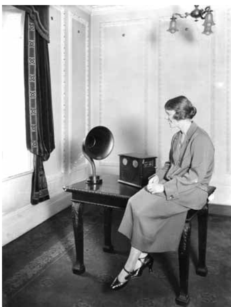
Fig. 116 - Signora in ascolto del radiorecettore domestico V2 (a due valvole) prodotto dalla Marconiphone.
