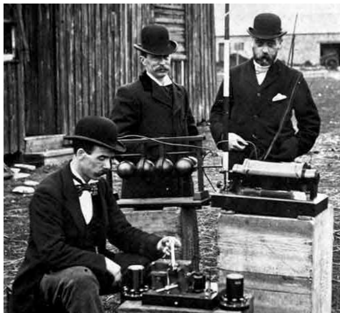
Fig. 29 - Dirigenti del Post Office con le apparecchiature utilizzate per gli esperimenti sul canale di Bristol nel 1897. In primo piano si vede il ricevitore, mentre al centro sono l'oscillatore e il rocchetto di Ruhmkorff.
