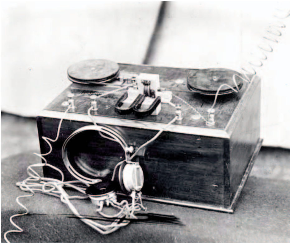
Fig. 58 - Detector magnetico costruito dalla Compagnia Marconi (1902). In questo modello il filo che passa all'interno della bobina è azionato da due ruote collegate a un motore.
