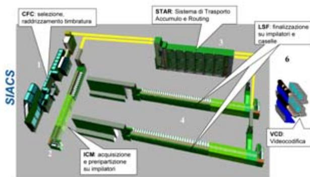
**Figura 1 – Struttura di un Sistema Integrato di Accumulo, Codifica e Smistamento (SIACS).**
