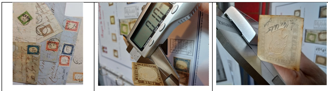
Figura 11: Esempio di misura dello spessore della carta
