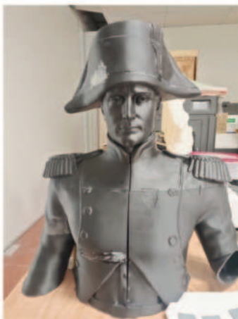
Differenti fasi del processo di riproduzione: dalla stampa dei vari pezzi, all'assemblaggio, alla stuccatura.
