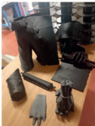
Differenti fasi del processo di riproduzione: dalla stampa dei vari pezzi, all'assemblaggio, alla stuccatura.
