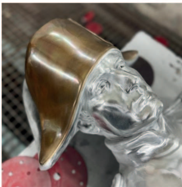
Differenti fasi della metallizzazione: lucidatura e bronzatura.
