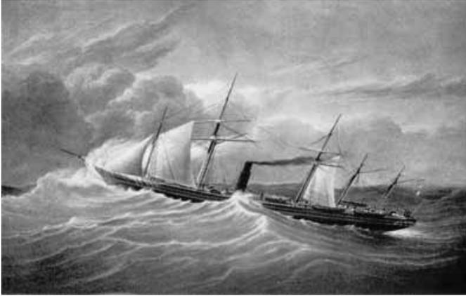
Varato il 19 ottobre 1865 dai cantieri J.&G.Thomson di Glasgow con due motori alternativi, scafo in ferro, propulsione a vela ed elica, con tre gru di carico, un fumaiolo e due alberi, velocità 11 nodi, passeggeri 1<sup>a</sup> classe n° 40 e n° 535 in 3<sup>a</sup> classe.
