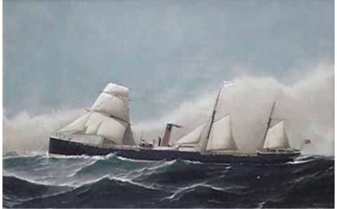
Varato nel 1864 dai cantieri Tod & McGregor di Glasgow, con motori a due cilindri, scafo in ferro, propulsione a vela ed elica, un fumaiolo e tre alberi, velocità 12 nodi, passeggeri 1<sup>a</sup> classe n° 300 e n° 800 in 3<sup>a</sup> classe.
